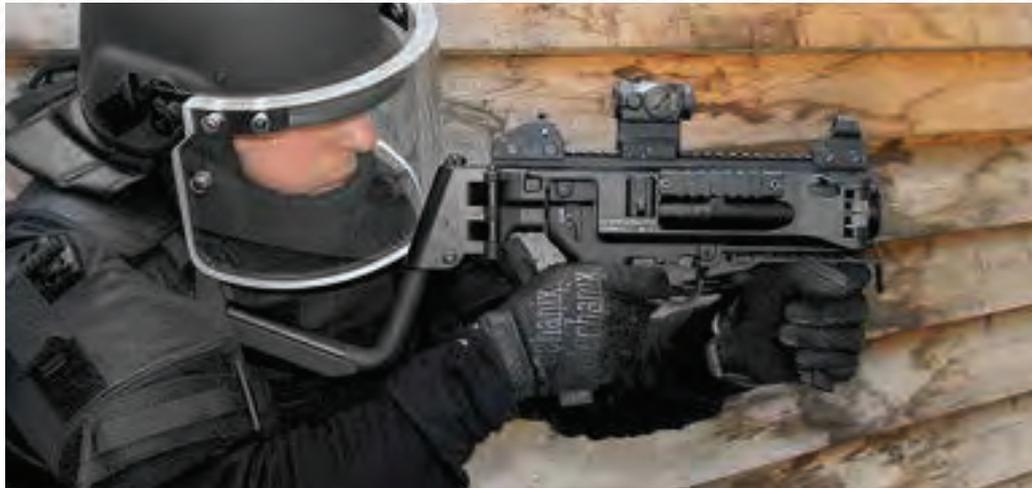
Abb. 14: HK269-Werfer mit sog. Helm-Schulterstütze. Da inzwischen nicht nur Spezialkräfte, sondern auch zunehmend reguläre Polizeivollzugsbeamte bzw. First Responder mit sog. Calimero-Schutzhelmen und insbesondere auch relativ sperrigen ballistischen Helmvisieren ausgestattet werden, kommt bei der Einsatz- und Beschaffungskonzeption den hierzu passenden Helmschulterstützen und sog. Spacern zur Visierlinienerhöhung besondere ergonomische bzw. einsatztaktische Bedeutung zu.
